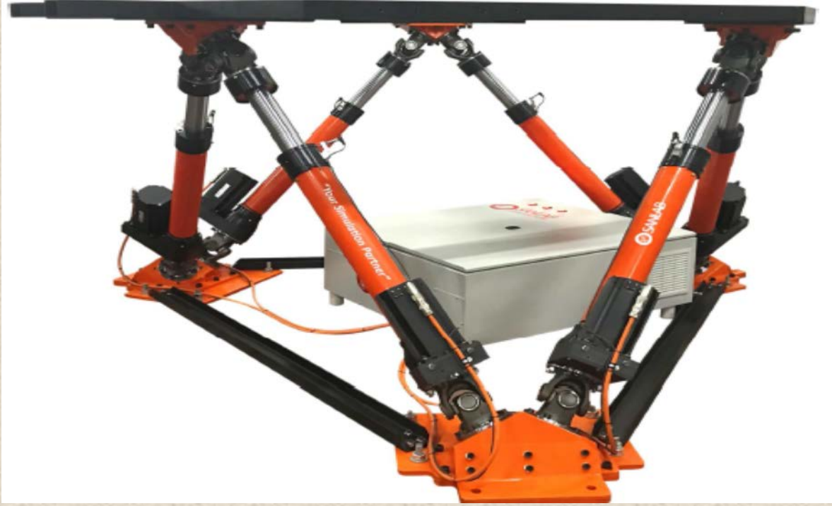
Resim: 6DOF Hareketli Platform ve Aktüatör, SANLAB, Konya
