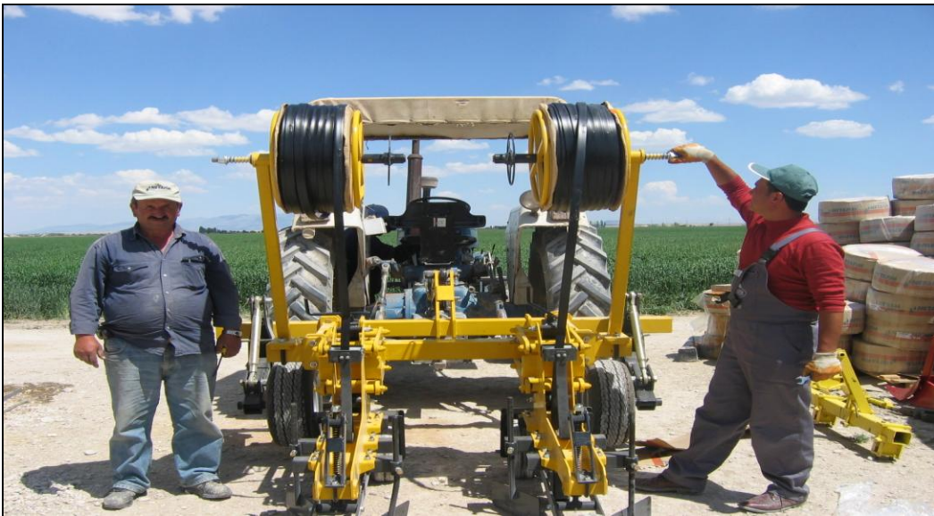
Şekil 9 Örnek lateral gömme makinesi
